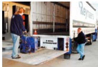
Električno dvigalo za zlaganje na tovarnjak
