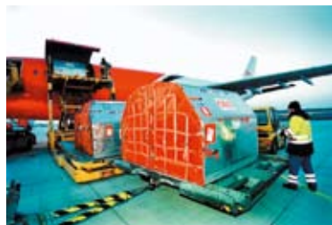
Samodejno nakladanje naprave za transport kosovnega tovora v letalo
